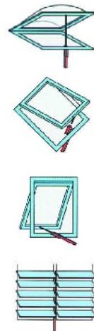
**ST450N** - штоковый привод для автоматизации фрамуг с верхним подвесом, мансардных окон, световых люков, наружных жалюзи.
