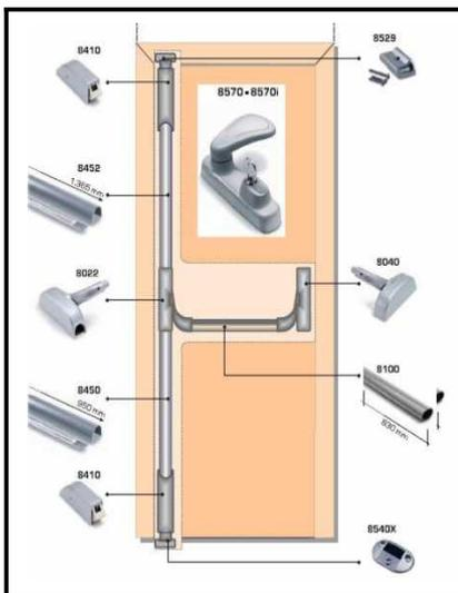
В систему антипаника Panama (Farim) с двумя точками запираения для противопожарных дверей входят элементы:
