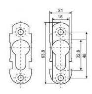
Характеристики: Накладка на цилиндр замка со сдвижной маской Противосъемная конструкция Материал - силумин Покрытие — электростатическая покраска по RAL-y
