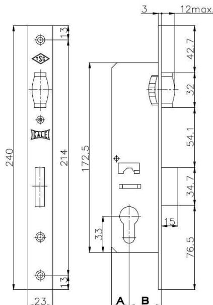
Замок врезной цилиндрический
