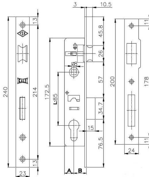
Замок врезной цилиндрический
