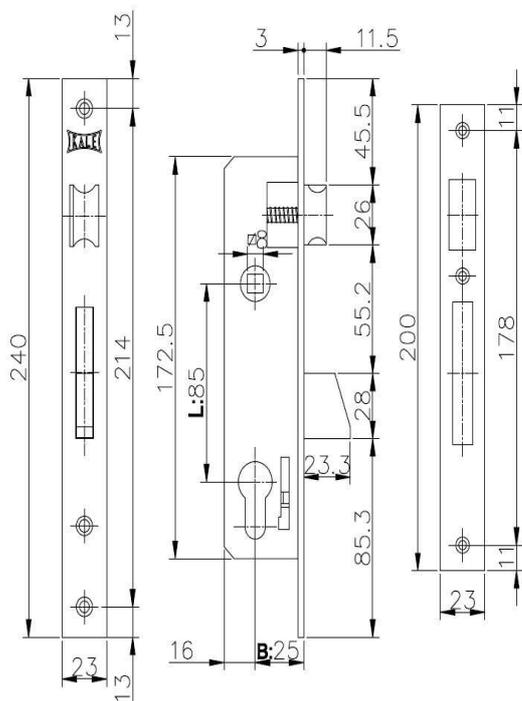
Замок врезной цилиндрический
