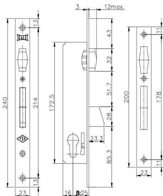
Замок врезной цилиндрический
