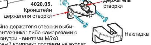
Крепление кронштейна держателя створки выбирается по усмотрению монтажника: либо саморезами с лицевой стороны, либо изнутри - винтами M5x8. Саморезы и винты в базовый комплект поставки не входят.
