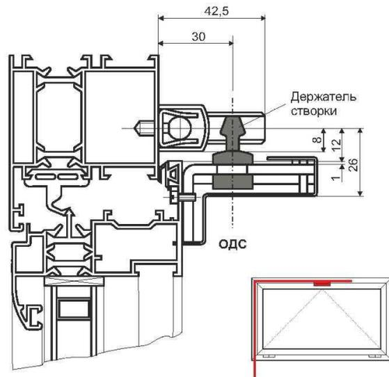
✓ При ширине фрамужной створки более 1200 мм используются дополнительные фрамужные ножницы в комплекте с держателем створки - 4020.20. Смотрите схему:
